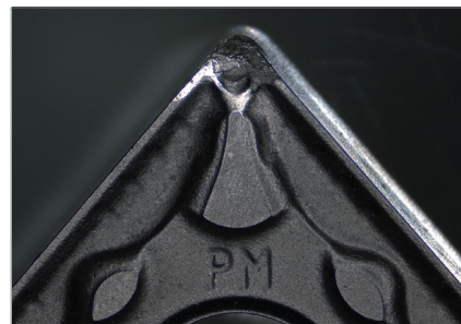
Inserto indexable, muestra el desgaste de la herramienta. Luz reflejada, luz de timbre, zoom 0.8x
